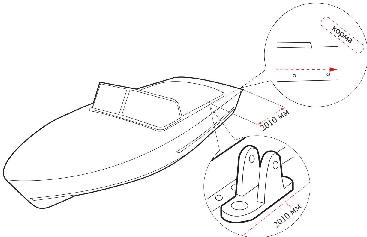
1. Установите кронштейн крепления дуг к корпусу лодки, на расстоянии 2010 мм (по центру кронштейна) от корпуса лодки со стороны кормы (см. рис). На нашем сайте, в разделе «инструкции» мы можете посмотреть фотографии размеров.
